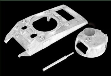
坦克主要部份炮塔及车体均采用合金制造, 主炮管采用数控车床切割而成
